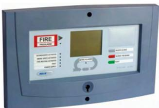
Подключается к панелям серии FX/RU по интерфейсу RS485 с использованием Info-протокола. Скорость передачи данных - 1200 бод. Без конфигурации отображает те же тревоги, что и панель серии FX/RU. С помощью программы WinFMPX можно настроить панель FMPX/RU на тревоги определенных зон. Суммарно к одной панели серии FX/RU можно подключить до 16 устройств MCOX, REPX и FMPX.
