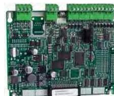
В системе может быть только один модуль MCOX. Он должен быть первым устройством в цепочке устройств, подключенных к порту Info-протокола.
