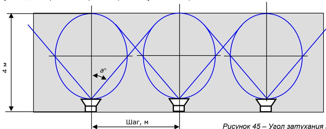
Рисунок 45 – Угол затухания звукового давления
