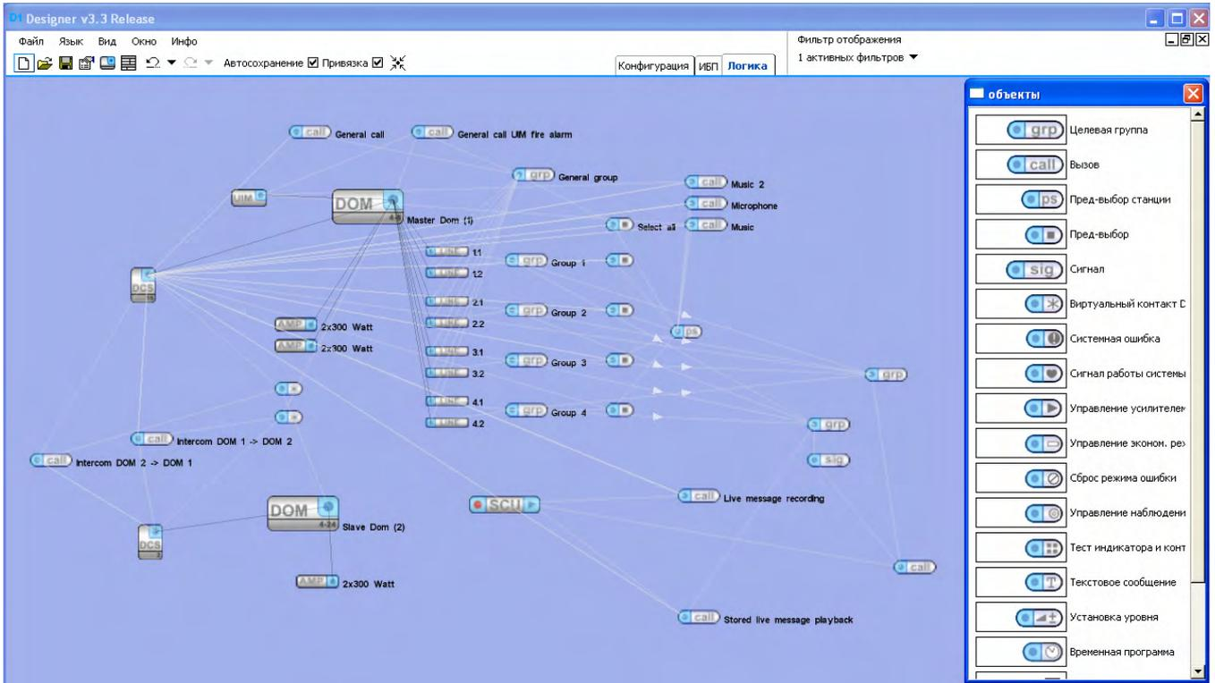
Рисунок 55 – Создание логической конфигурации системы в D1 Designer
