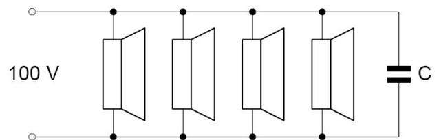
Рисунок 36 - Подключение оконечного конденсатора
