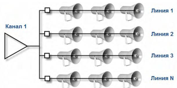
Рисунок 32 – Мультилинейная схема подключения
