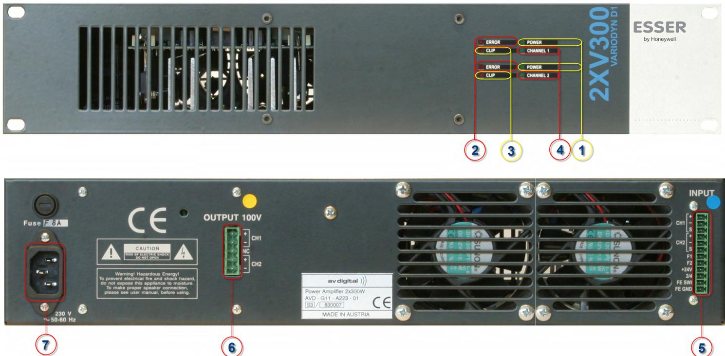
Рисунок 16 – Лицевая и задняя панели двухканального усилителя мощности Variodyn
