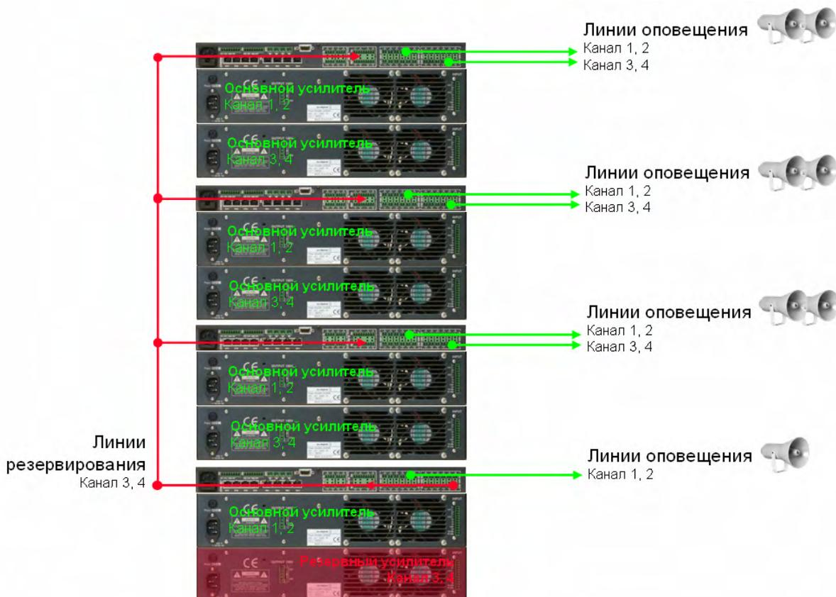
Рисунок 23 – Принцип организации резервных каналов усиления в системе Variodyn D1
