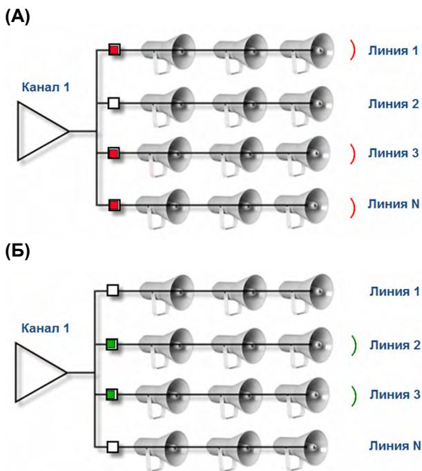
Рисунок 33 - Пример работы мультилинейной схемы
