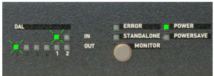
Рисунок 2 – Пример диагностической индикации при использовании кнопки "Monitor"
