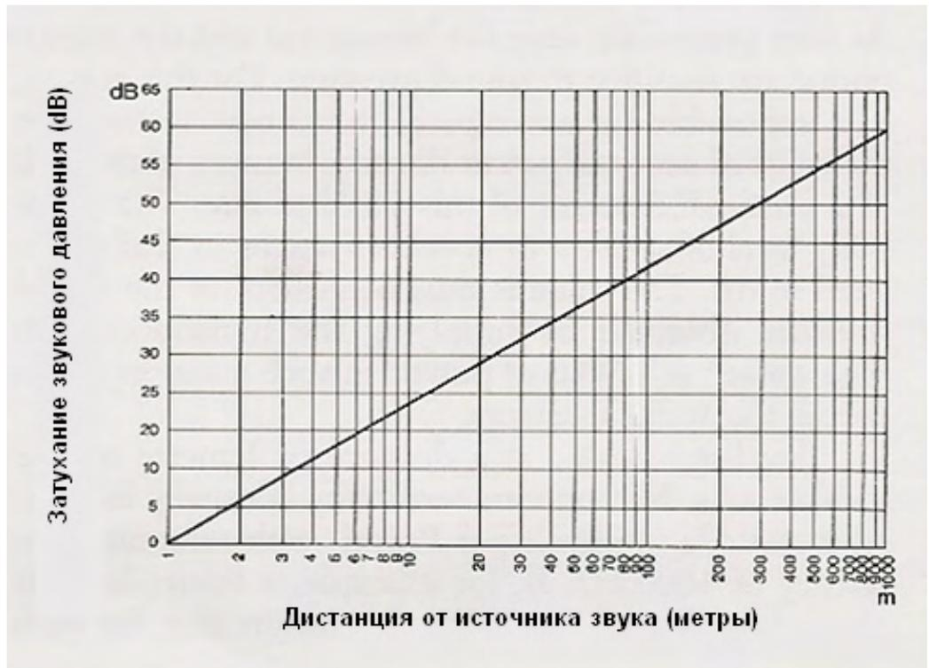
Рисунок 44 – Диаграмма затухания звукового давления в зависимости от расстояния до звукового источника
