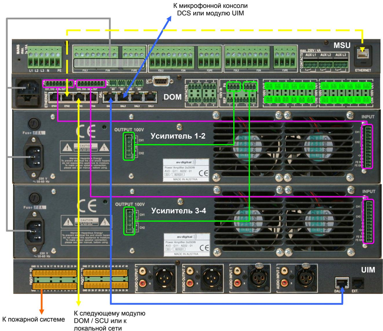
Рисунок 22 – Подключения основных элементов системы (модули DOM, UIM, усилители)
