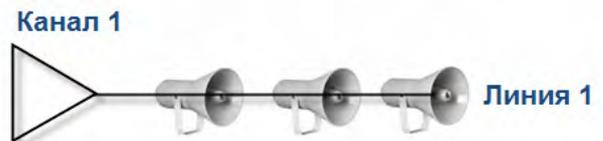
Рисунок 31 – Моноканальная схема подключения
