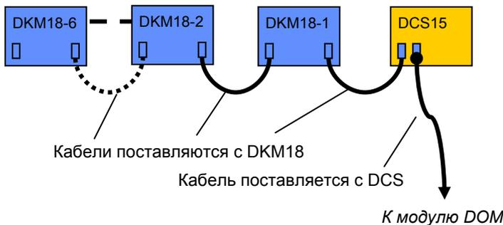
Рисунок 11 – Подключение модулей DKM18
