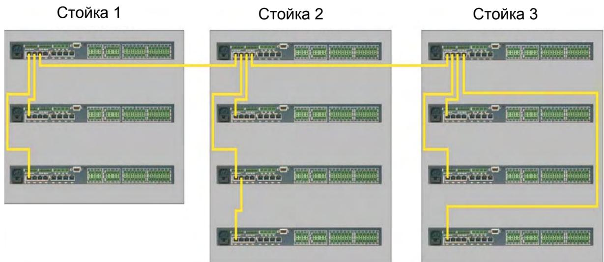
Рисунок 21 Пример распределённого подключения стоек (сетевое оборудование ЛВС не показано)
