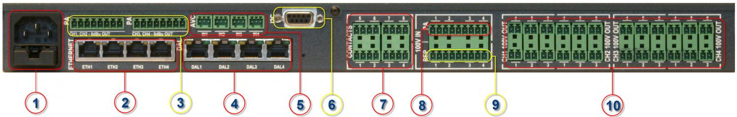
**1. Стандартный разъём IEC** для подключения сетевого питания и сетевой предохранитель
